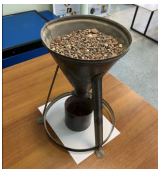
Рисунок 2.7– Определение насыпной плотности щебня с фракцией от 6 до 10 мм
