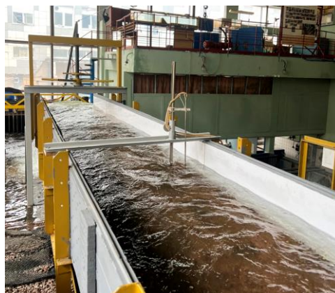
Рисунок 2.4 – Картина движения потока на модели, где происходит измерение скоростей потока трубкой Пито
