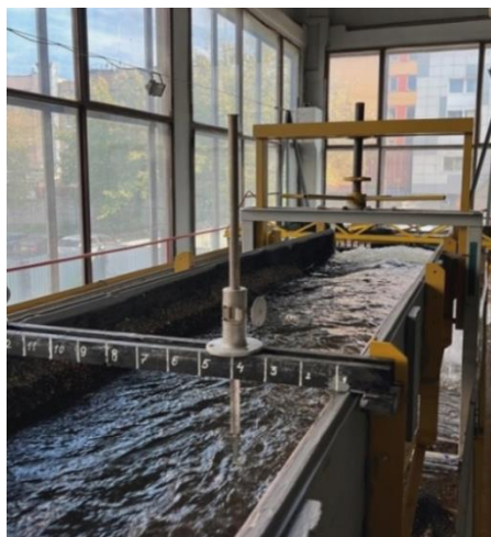
Рисунок 2.5 – Измерение уровней воды шпитценмасштабом
