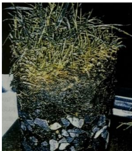
Рисунок 1.17 – Укрепление с травянистыми растениями: кern защитного крепления из известкового щебня и мастики [59]
