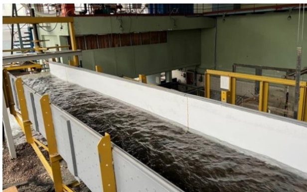
Рисунок 3.1 – Вертикальная стенка лотка, покрытая глянцевыми пластмассовыми листами
