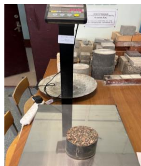
Рисунок 2.7– Определение насыпной плотности щебня с фракцией от 6 до 10 мм
