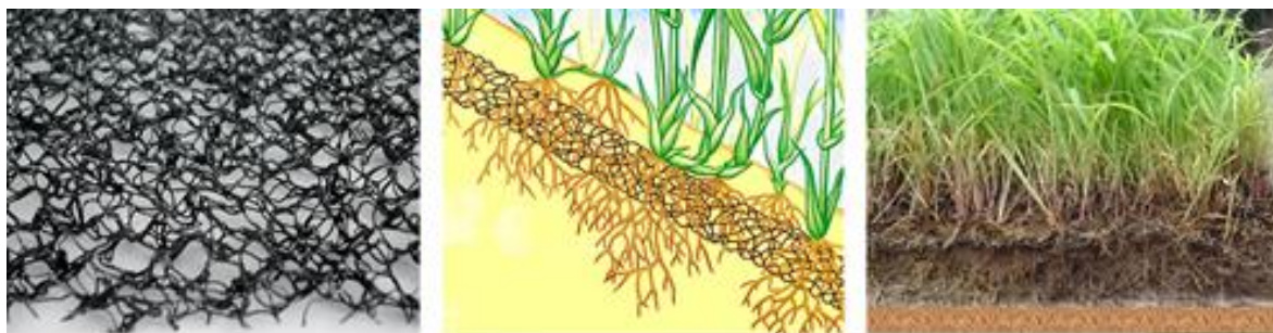
Рисунок 1.14 – Использование противозэрозионного покрытия в виде геомата с посевом трав [45]
