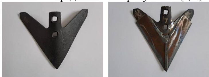
Рисунок 11 – Лапа культиватора КРН-220 до испытаний: а – серийная деталь, б – деталь с приваренными пластинами
