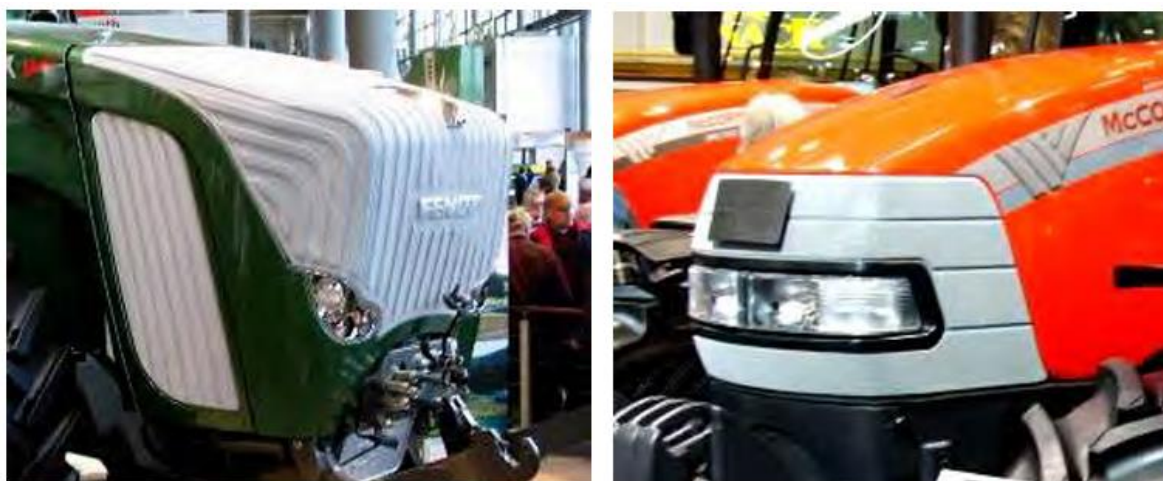
Рисунок 1.5 Пример большой решетчатой панели в виде штампосварной детали сложной геометрии
