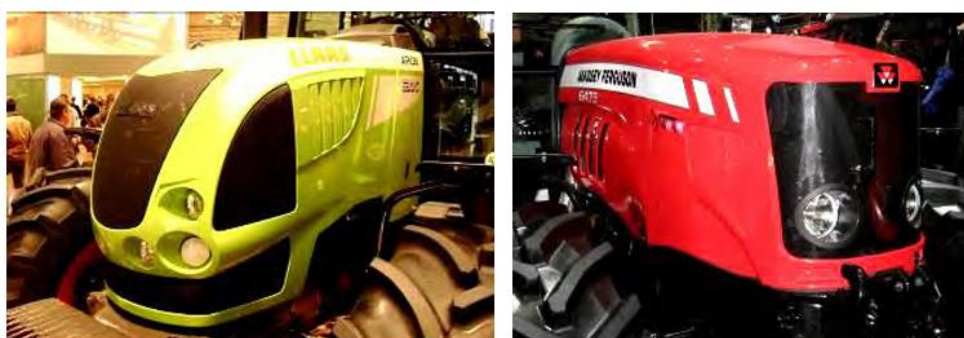
Рисунок 1.4 Применение пластиков и пластмасс для капотов, крыши и крыльев кабины
