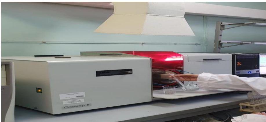
Рис.10. Определение содержания минералов методом атомно-абсорбционной спектрометрии (ААС)
