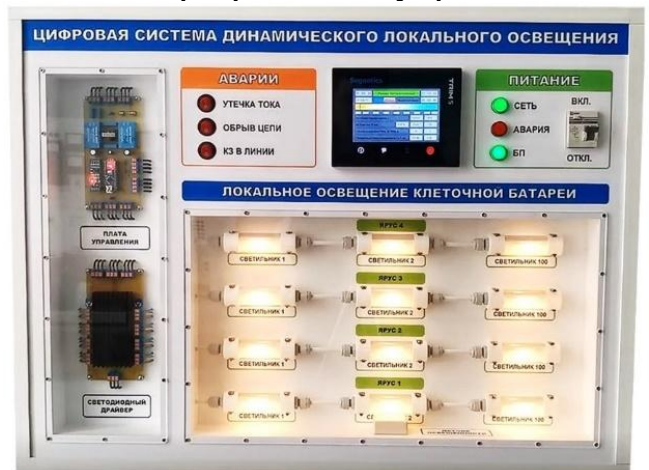
Рисунок 9 – Разработанный экспериментальный образец динамической системы освещения
