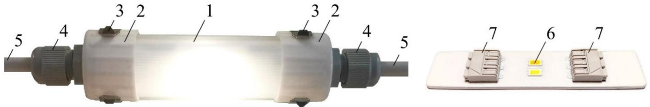
Рисунок 5 – Разработанный светильник и печатная плата для светодиодов
