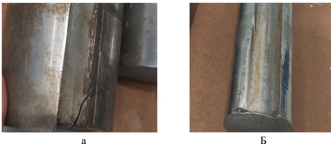
Рисунок 1.9 – Шпоночный паз вала с дефектами:
