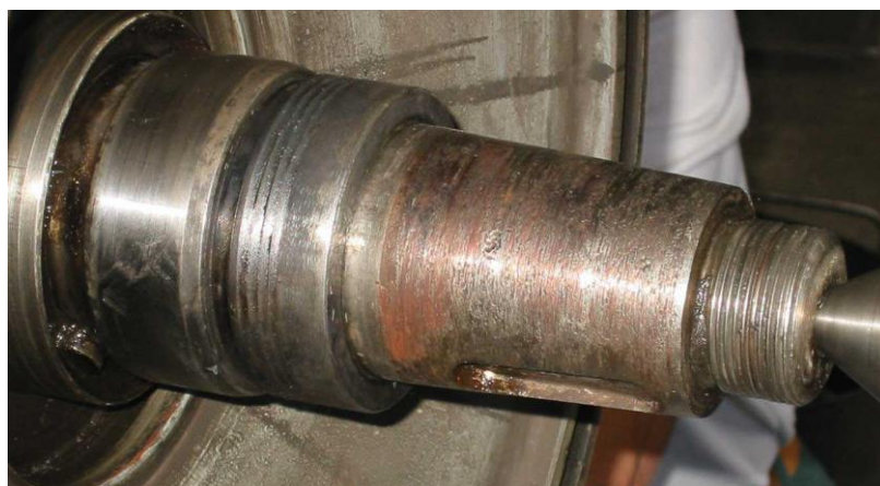
Рисунок 1.10 – Фреттинг коррозия вала
