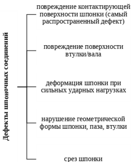
Рисунок 1.11 – Дефекты шпоночных соединений
