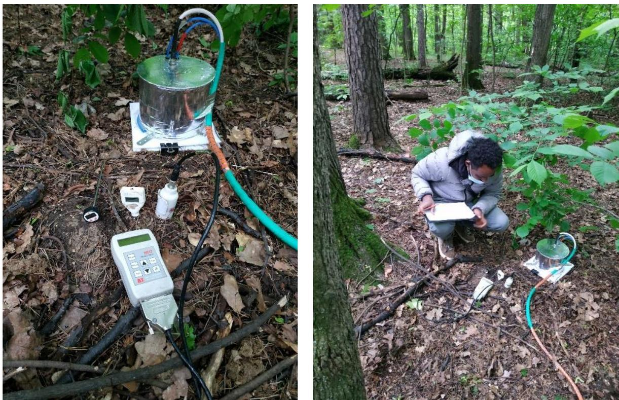
Рисунок 2.3.1. Измерение почвенных потоков  $\text{CO}_2$  на ключевых участках мониторинга с одновременным измерением температуры и влажности почвы
