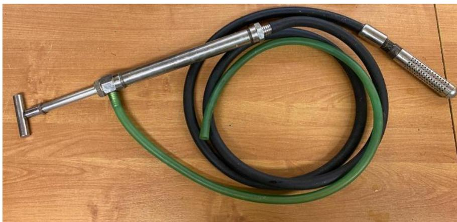
Рис. 8. Зонд для отбора рубцового содержимого
