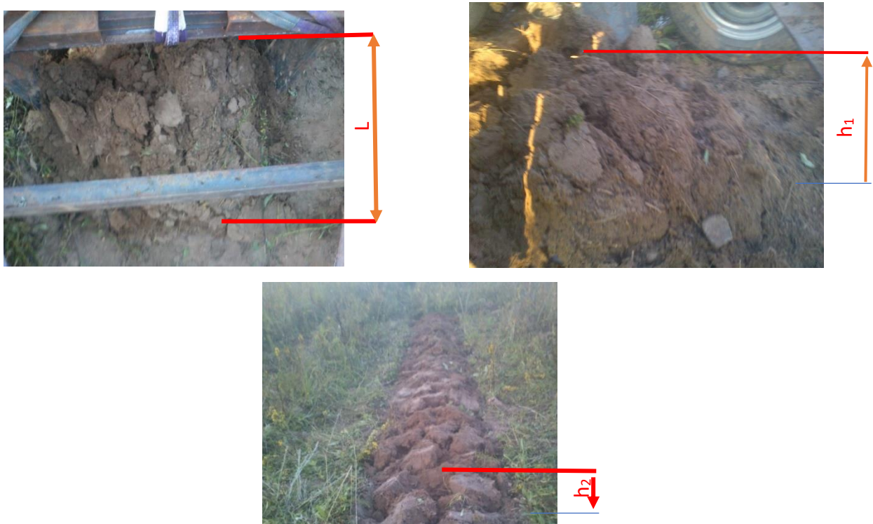
Рисунок 4.15 – Измерение параметров, характеризующих процесс рыхления в полевых условиях
