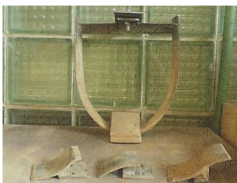
Рисунок 3.10 – Форма рабочих поверхностей моделей лемеха
