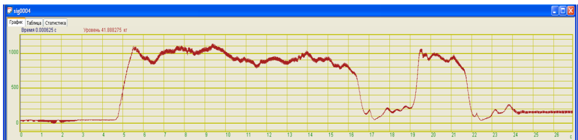
Рисунок 4.18 – Запись тягового усилия. На графике отложено: по оси ординат - усилие в Н; по оси абсцисс - время в секундах
