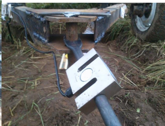
Рисунок Ж. 2 – Установка и схема подключения датчика
