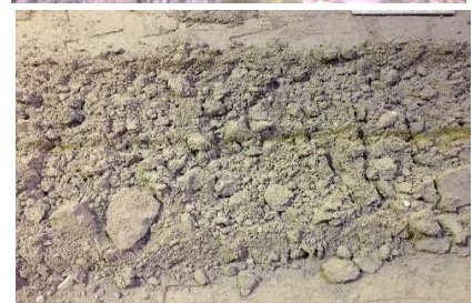
Рисунок 4.13 – Распределение агрегатов грунта для рабочего органа с параболическими стойками с различным дополнительным оборудованием
