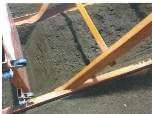
Рисунок 3.17 – Приспособление для получения срезов грунта
