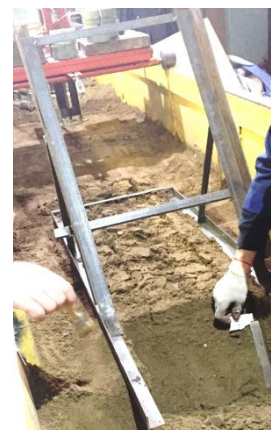
Рисунок 3.17 – Приспособление для получения срезов грунта
