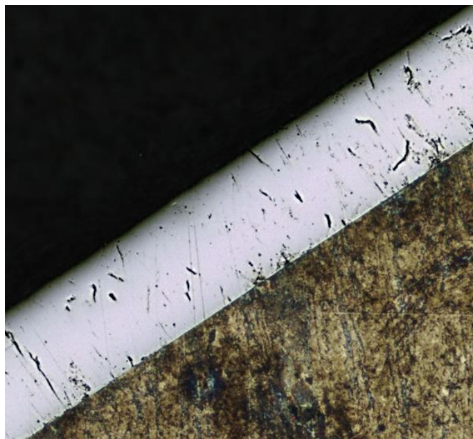
Рисунок 4.3 – Микроструктура поверхностного слоя стали 12Х2Н4А после нанесения карбидохромового покрытия при давлении вакуума 0,1 Па, температуре подложки 195 °С и реакционной среды 60°С и скорости подачи реакционной среды 3,0 л/час, толщина покрытия 270 мкм.
