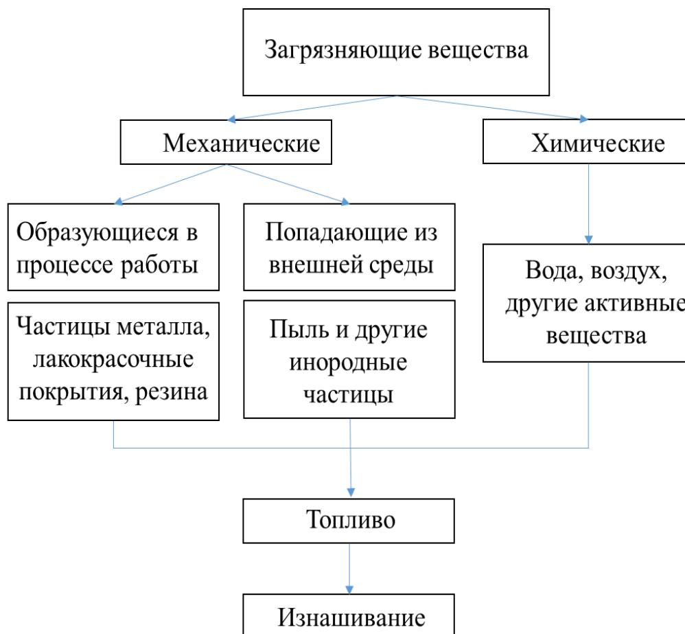
Рисунок 1.4 – Характеристика загрязняющих веществ, приводящая к изнашиванию прецизионных поверхностей.
