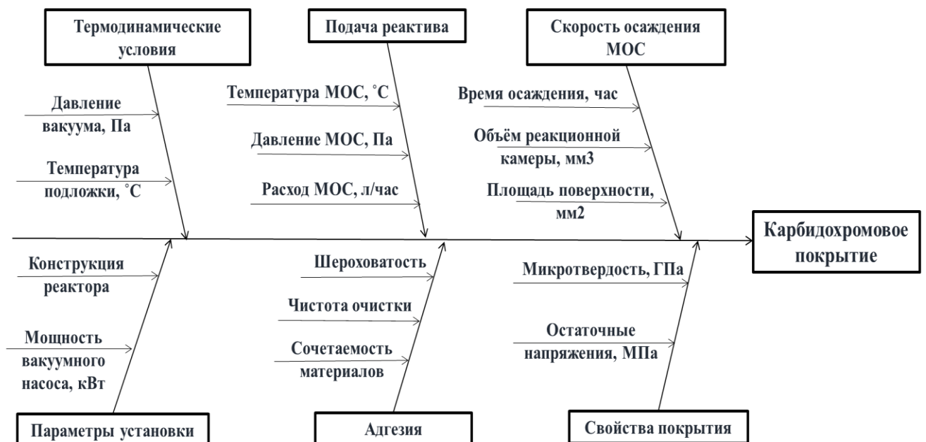
Рисунок 3.6 – Факторы, влияющие на осаждение карбидохромового покрытия.
