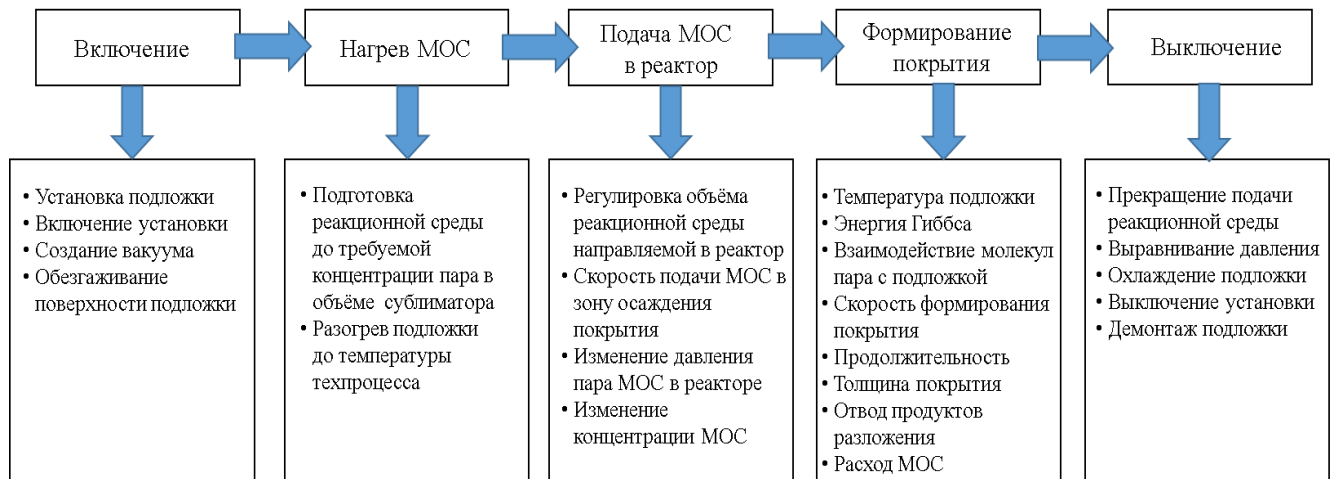
Рисунок 3.5 – Схема технологического процесса формирования износостойкого покрытия на деталях.
