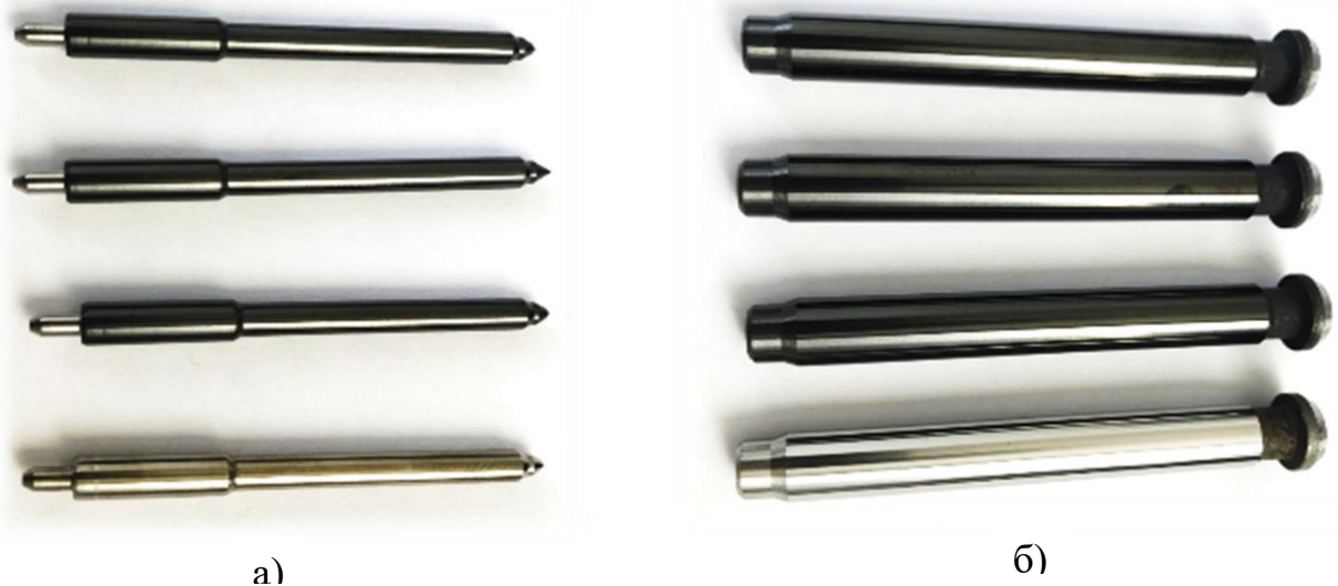
Рисунок 1.12 – Углерод – алмазные покрытия (DLC):
