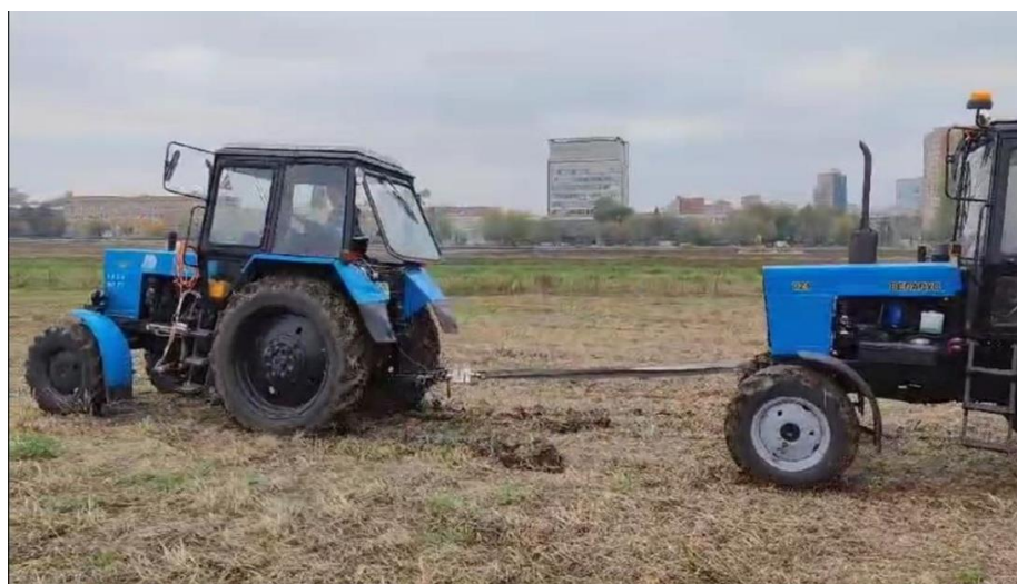
Рисунок 6 – Трактор-тягач МТЗ – 82 в сцепке через транспортный фал с трактором-нагрузкой в процессе полевых исследований
