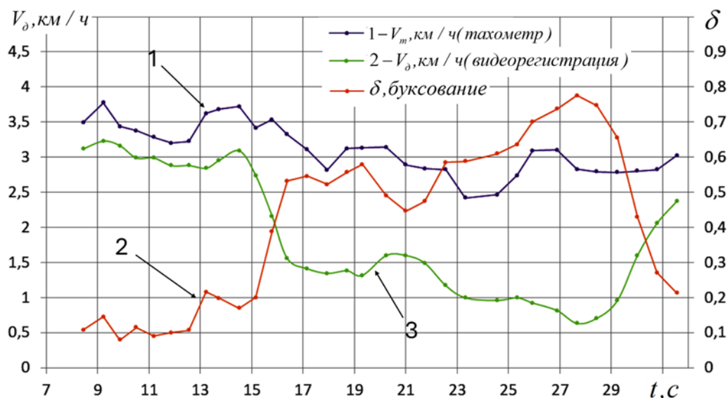
Рисунок 12 – Пример обработки результатов регистрации на стерне.
