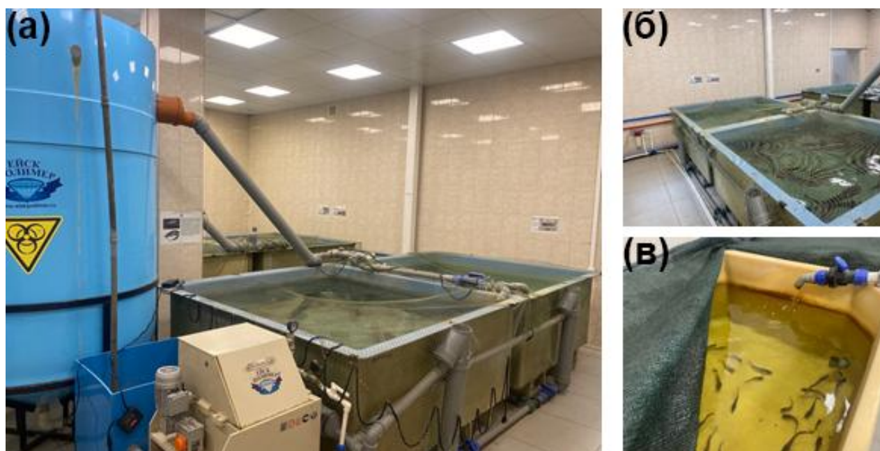
Рисунок 9 –Участок тепловодной аквакультуры с УЗВ для содержания и выращивания рыб
