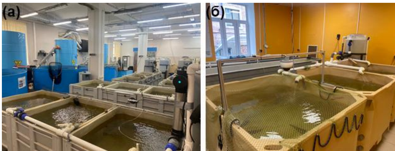
Рисунок 10 – Установки с замкнутым циклом водоснабжения для выращивания молоди африканских сомов в «Центре Аквакультуры» ФБиРХ МГУТУ им. К.Г. Разумовского (ПКУ): а – модули УЗВ для акклимации особей, б – модули УЗВ для выращивания молоди
