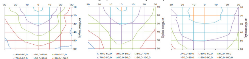
Рисунок 6 – Контура увлажнения вариантов орошения 60-80%NB, 70-90%NB и 80-100%NB соответственно в 2025 году (слева направо)
