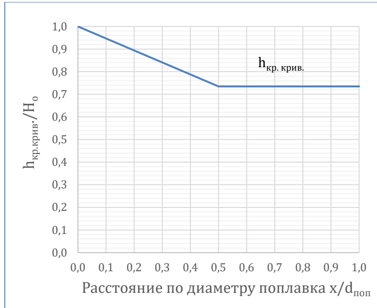
Рисунок 2.18 – Расчётная схема пригрузки поплавка переливающимся слоем воды
