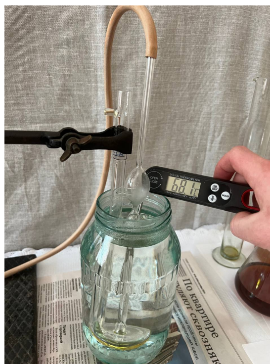
Рисунок 3.5 – Лабораторный стенд для снятия показаний вязкости топлива
