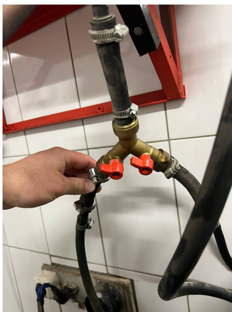
Рисунок 4.6 – Топливная магистраль для переключения подачи (основной бак/бак со смесью)
