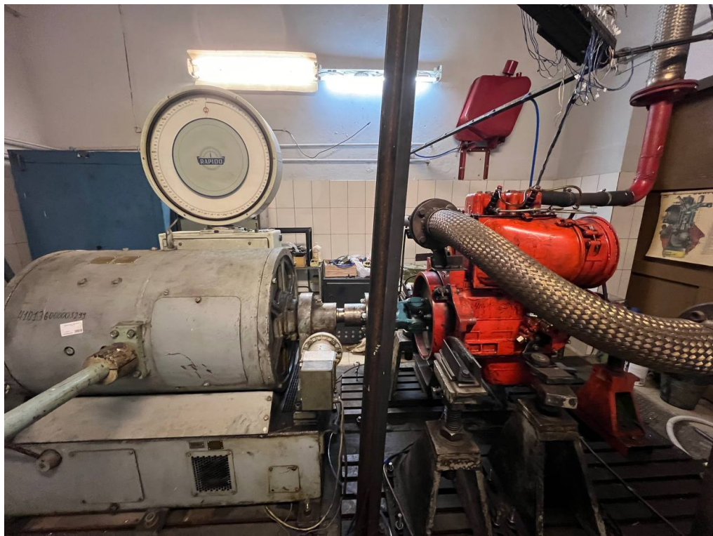
Рисунок 4.4Б – Общий вид установленного на стенде двигателя Д-21 No 1002015 (вид из операторской)
