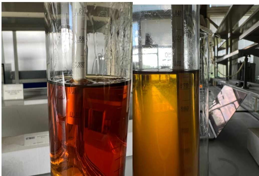
Рисунок 3.4 – Измерение плотности смеси при 20 °С: а – чистый биодизель; б – смесь 50/50
