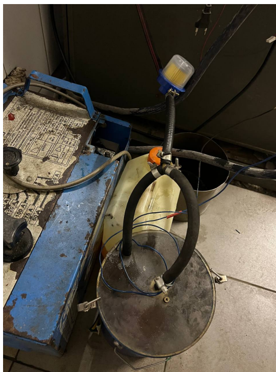
Рисунок 4.5 – Имитация топливного бака для подачи смеси
