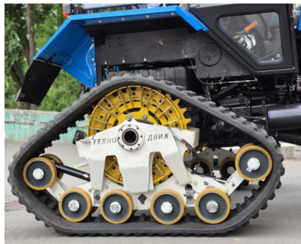
Рисунок 12 – Внешний вид съемного тягово-гусеничного модуля
