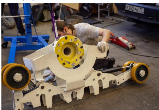
Рисунок 13 – Процесс сборки рамы заднего тягово-гусеничного модуля:
