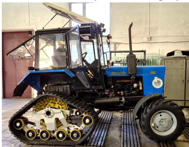
Рисунок 12 – Внешний вид съемного тягово-гусеничного модуля
