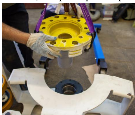
Рисунок 13 – Процесс сборки рамы заднего тягово-гусеничного модуля:
