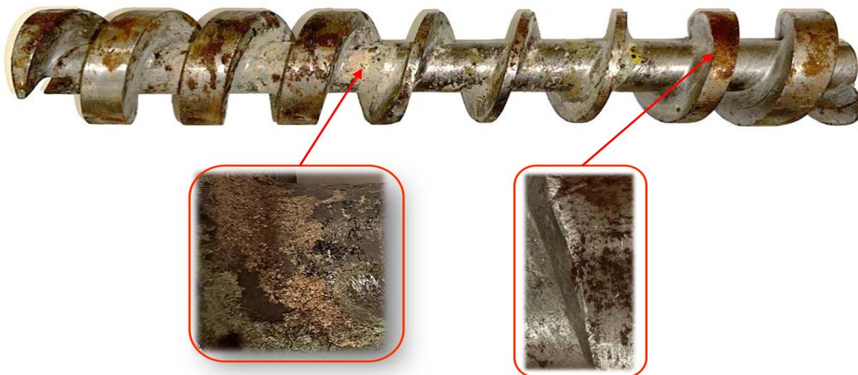
Рисунок 3 – Коррозионно-механический износ шнека кормового экструдера
