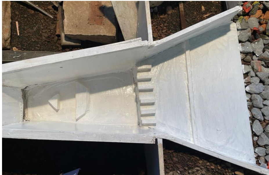
Рисунок 4.7- Модель с энергогасителями, аналогичными схеме гасителей в нижнем бьефе водосброса Нижне-Кафирниганского гидроузла (схема 2)
