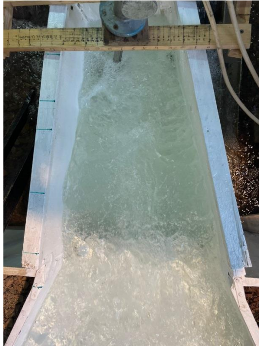
Рисунок 4.11 - Плановая картина сопряжения на водобойном колодце схемы 2 при Q = 900 \text{ м}^3/\text{с} , h_{\text{НБ}} = 4,9 \text{ м} : видны интенсивные процессы генерации вихрей и захвата воздуха в водобойном колодце
