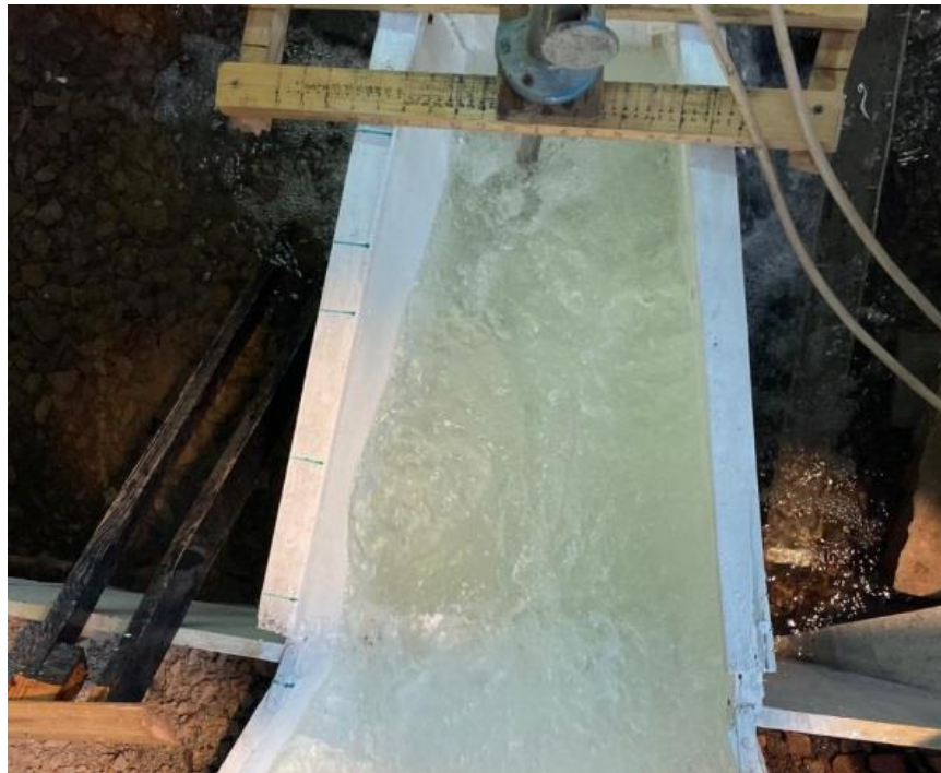
Рисунок 4.24 - Картина работы водобойного колодца при Q = 900 \text{ м}^3/\text{с} h_{НБ} = 4,9 \text{ м} (схема 4)
