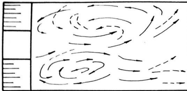
Рисунок 1.15 - Нижний бьеф шлюза-регулятора № 2 Кубань-Калаусской оросительной системы после 8 лет эксплуатации: поверхностные и донные линии токов
