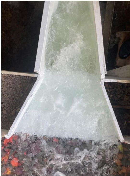
Рисунок 4.18- Картина работы водобойного колодца при Q=900\text{м}^3/\text{с} h_{НБ}=4,9\text{м} (схема 3)
