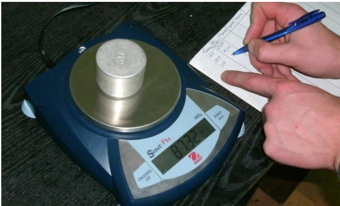
Рисунок 3.6 – Измерения влажности почвы для калибровки датчика
