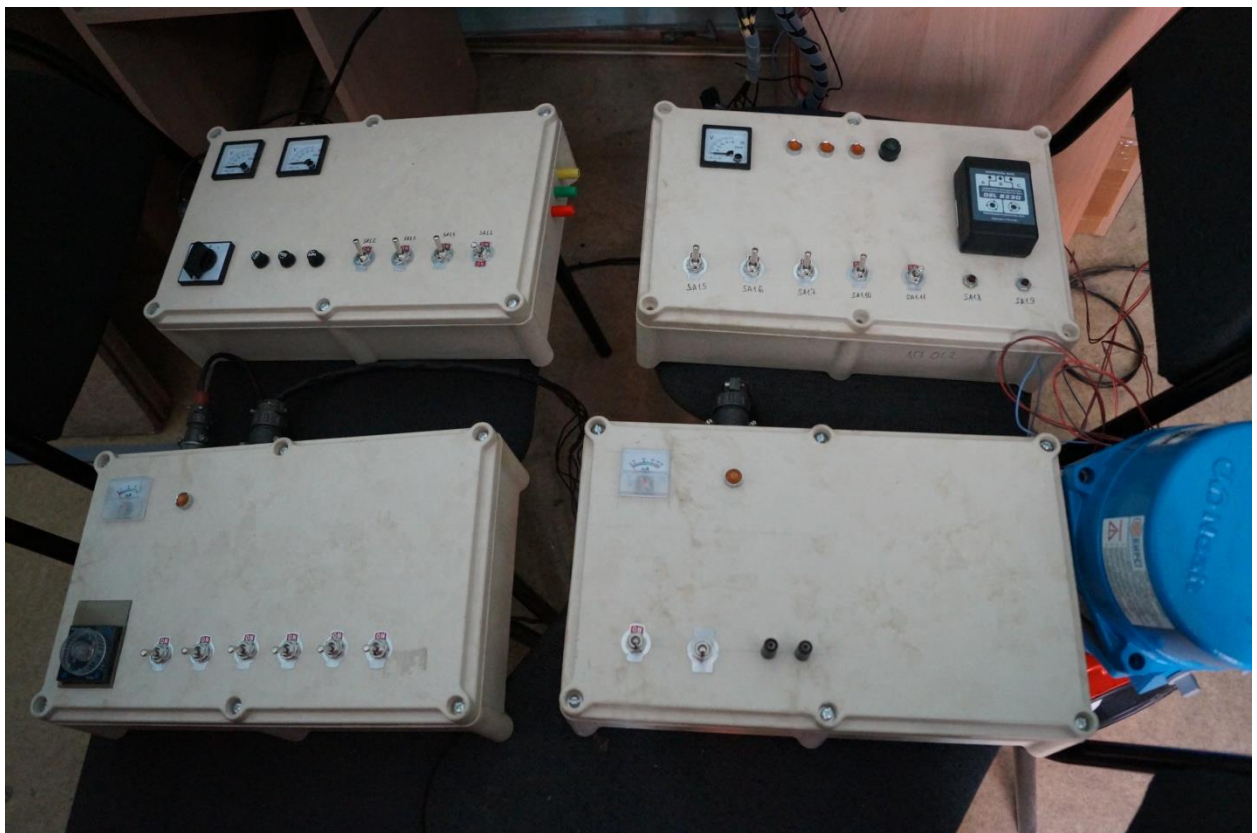
Рисунок 3.11 – Лабораторные приборы – имитаторы проверки проверялась системы управления
