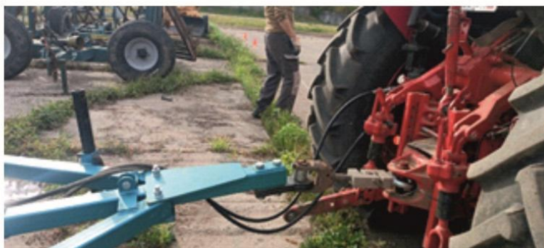
Рисунок 3.23 – Схема установки датчика ES-1-10t при проведении экспериментов
