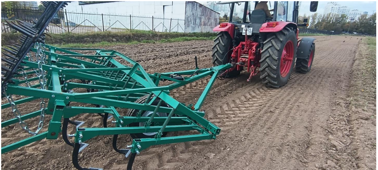
Рисунок 3.21 – К методике полевого опыта: а – стрелчатые лапы плоскореза с установленными ножами после диффузионного хромирования; б – культиватор КПС-4 в сцепке с трактором МТЗ-1523 при подготовке к работе
