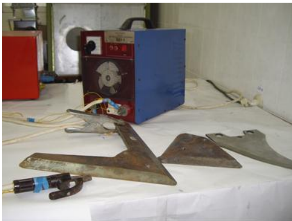
Рисунок 1.8 – Лапы культиваторов, упрочненные электродуговым нагревом
