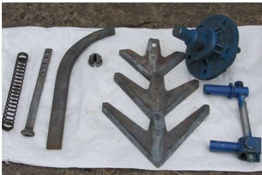
Рисунок 4.50 – Стрельчатые универсальные лапы культиватора КПС-4
