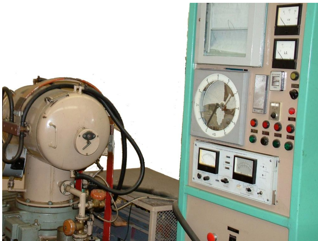
Рисунок 3.1 – Внешний вид вакуумной печи СНВЭ 1.3.1/16 ИЗ
