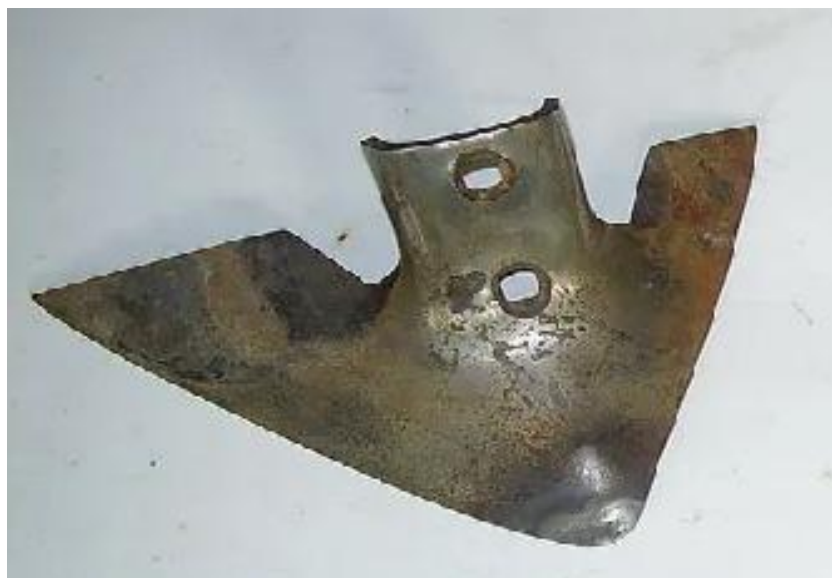
Рисунок 4.37 – Деформация и износ режущей кромки лапы культиватора в процессе эксплуатации в полевых условиях
