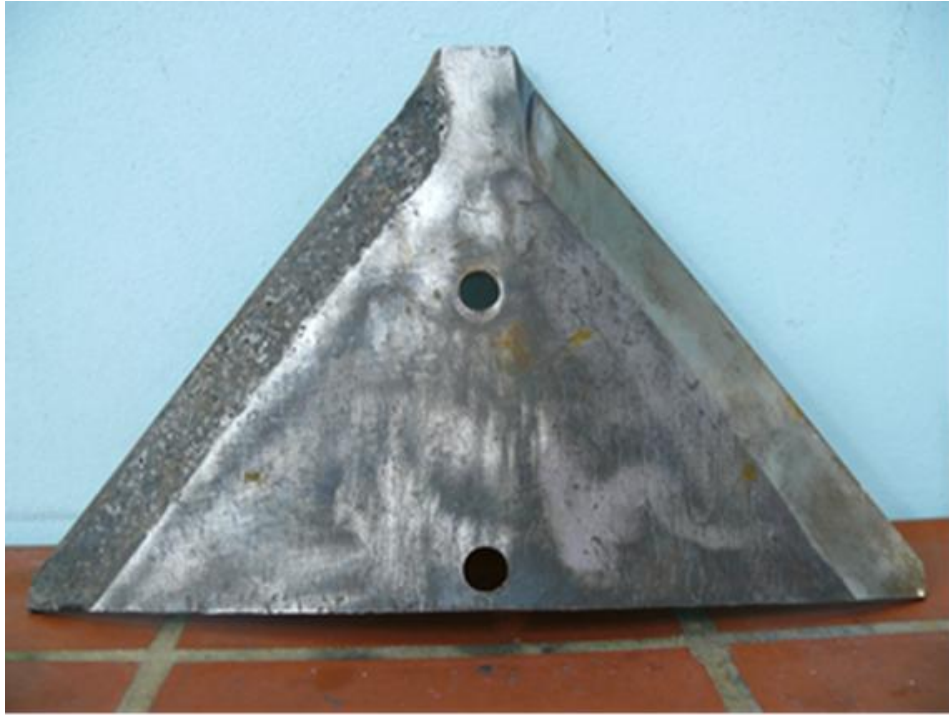
Рисунок 1.9 – Лапа культиватора, упрочненная боронитроцементацией
