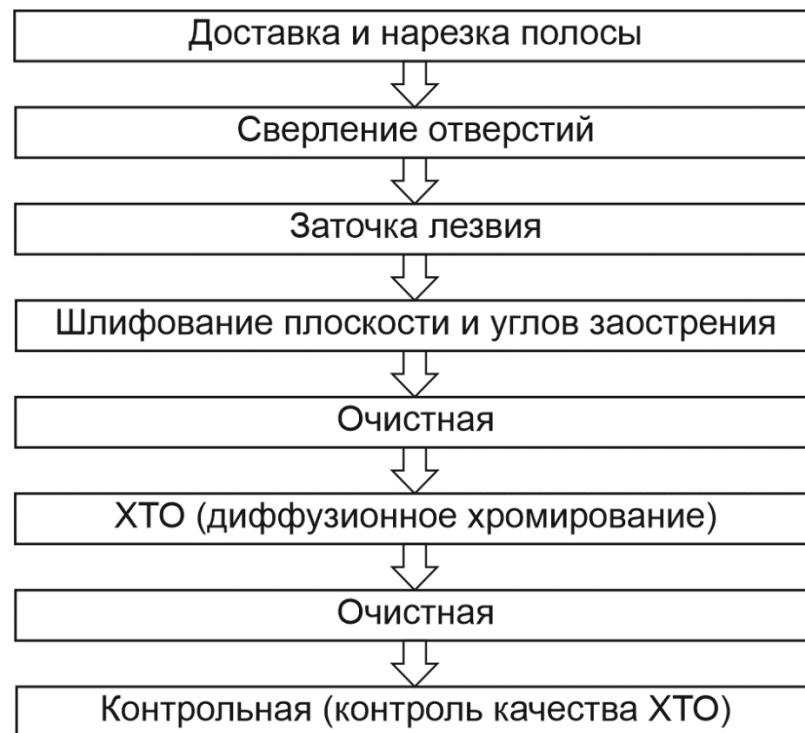
Рисунок 5.1 – Схема технологического процесса восстановления стрелчатых лап культиваторов
