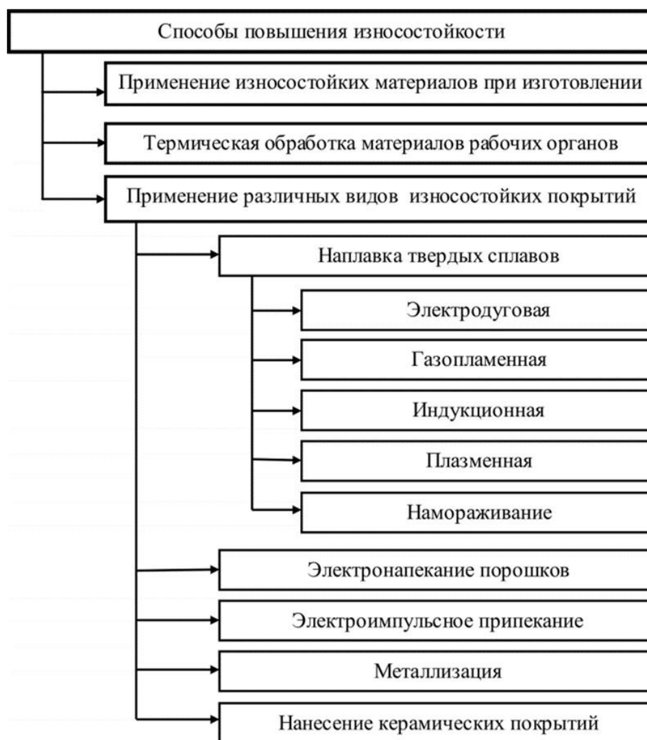
Рисунок 1.6 – Основные способы упрочнения рабочих органов почвообрабатывающей техники
