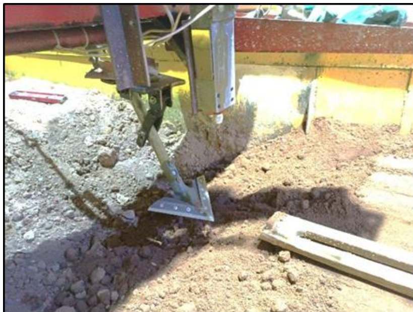
Рисунок 3.14 – Общий вид стойки с рабочим органом перед началом опыта
