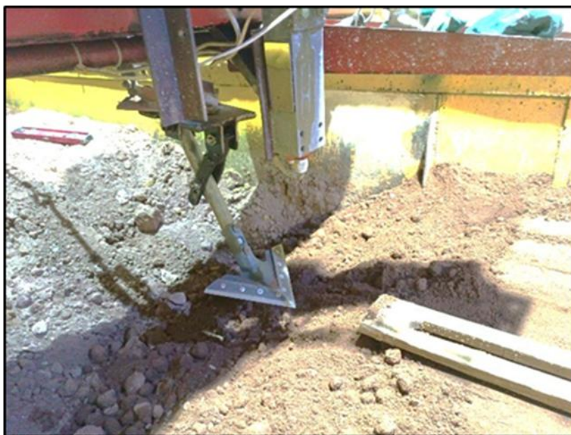
Рисунок 6 – Общий вид стойки с рабочим органом перед началом опыта
