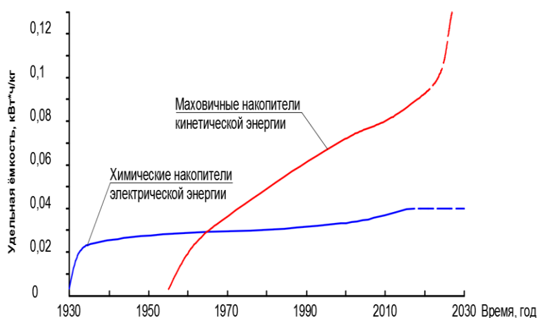
Рисунок 6.1. – Зависимости удельных энергоёмкостей химических и маховичных накопителей энергии от времени разработки.
