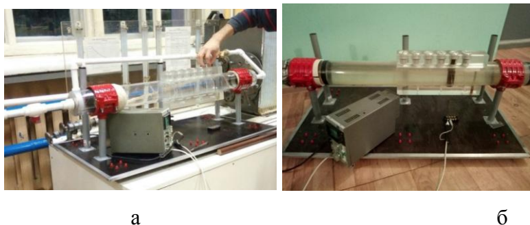
Рисунок 11 – Лабораторный стенд для исследования параметров вихревой дорожки Кармана
