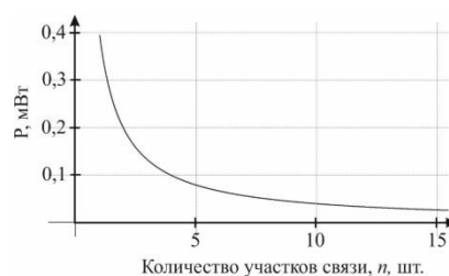
Рисунок 7 – Зависимость излучаемой мощности передатчика от количества участков связи
