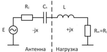
Рисунок 14 – Эквивалентная схема антенны с удлиняющей катушкой индуктивности
