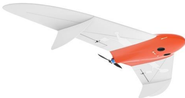
Рисунок 5.4 – Беспилотный летательный комплекс Геоскан 201 Агро [99]
