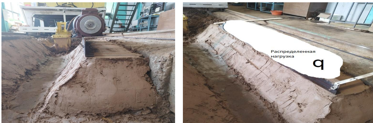
Рисунок 3.10 – Откос канала с распределенной нагрузкой по ребру швеллера
