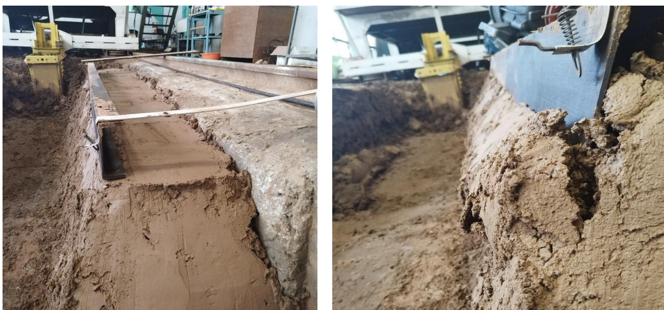
Рисунок 3.16 – Откос канала (75 градусов) с распределенной нагрузкой по ребру швеллера
