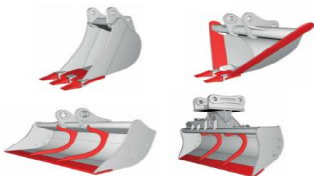
Рисунок 4.12 – Специальные ковши экскаваторов, применяемые для очистки каналов
