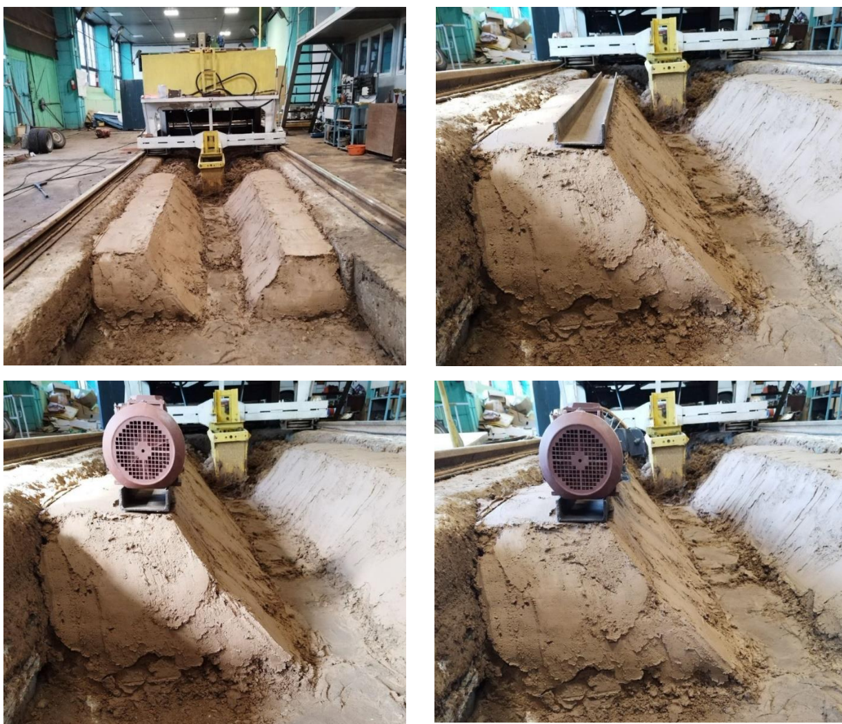
Рисунок 1 – Откос канала с распределенной нагрузкой по полке швеллера Результаты расчетов по данному опыту в системе GeoStab 8.1 представлены на рисунке 2. На рисунке 3 представлен анализ призмы сдвига при расчете откоса методом Филлениуса.
