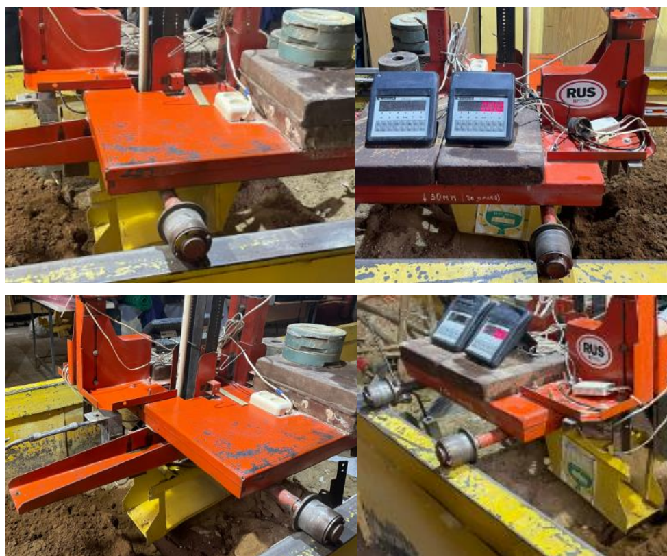
Рисунок 3.27 – Грунтовый канал с тележкой и моделью рабочего органа каналоочистителя PP-303
