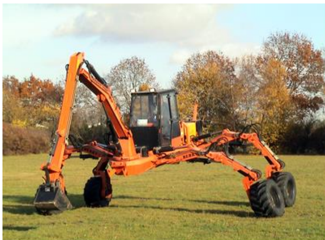
Рисунок 4.16 – Ходовое оборудование повышенной проходимости для внутри-канальных каналоочистителей
