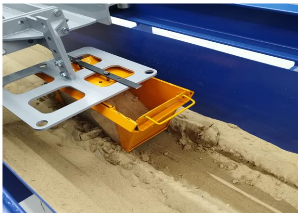
Рисунок 4.32 – Проектирование, изготовление и испытание модели рабочего органа каналоочистителя прямоугольного профиля
