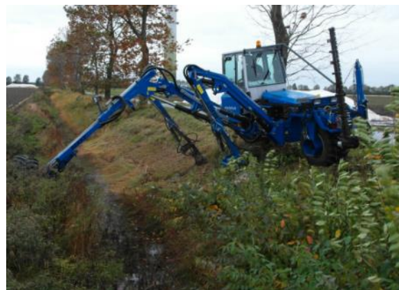
Рисунок 4.15 – Каналоочиститель с боковой навеской рабочего оборудования
