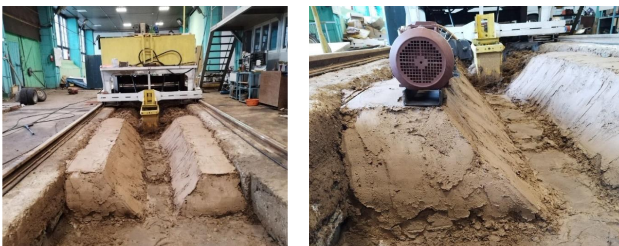
Рисунок 3.3 – Откос канала с распределенной нагрузкой по полке швеллера
