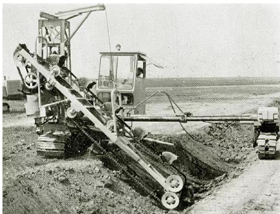
Рисунок 4.6 – Каналоочиститель ЭМ-152, работающий по консольной и седлающей схеме
