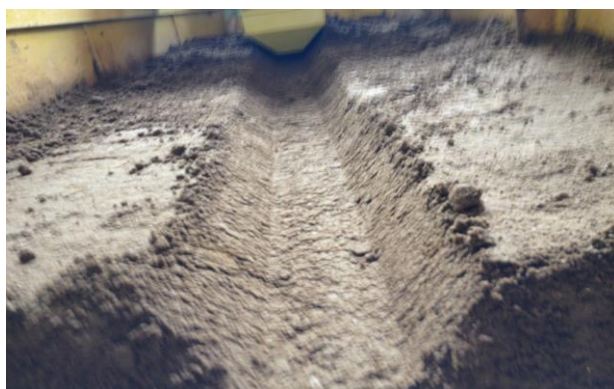
Рисунок 4.25 – Экспериментальные испытания ковша трапецеидального профиля
