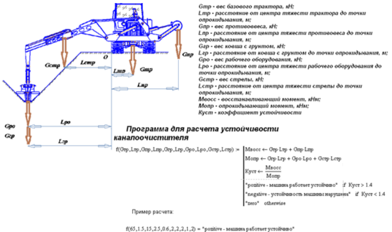
Рисунок 2.8 – Расчетная схема и мини программа в системе Mathcad для определения коэффициента устойчивости каналоочистителя PP-303
