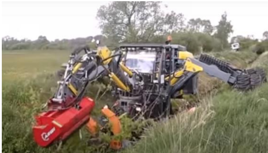
Рисунок 1.6 – Каналоочиститель внутриканальный (седлающая схема)
