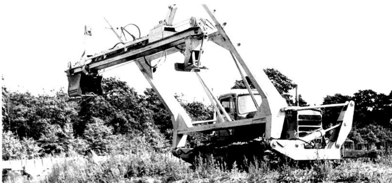
Рисунок 2.6 – Каналоочиститель РР-303 на базе трактора ДТ-75 в момент опускания рабочего оборудования в канал
