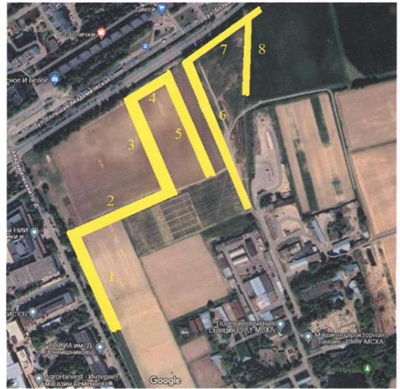
Схема производства работ по очистке каналов Полевой опытной станции РГАУ-МСХА имени К.А. Тимирязева в рамках полевых испытаний ковшея каналоочистителя ОКН-0,5
