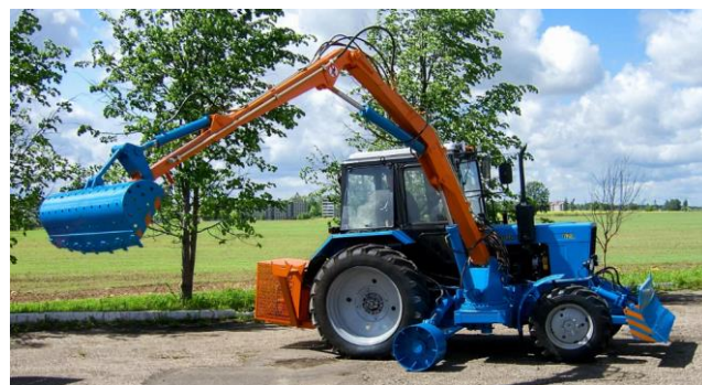
Рисунок 4.11 – Одноковшовый каналоочиститель на тракторной базе
