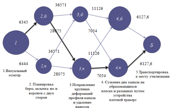
Рисунок 5.11 – Сетевой граф базового и нового комплексов машин при доступности всех машин
