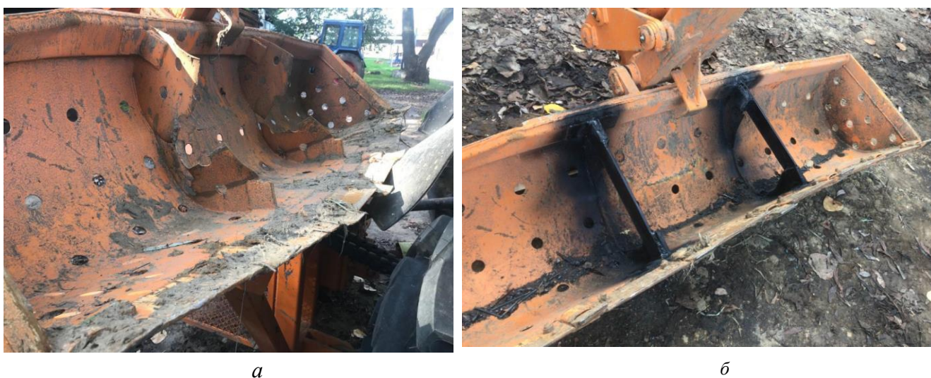
Рисунок 3.32 – Ковш каналочистителя: а - поломка ребер жесткости ковша каналочистителя ОКН-0,5 в местах сепарационных отверстий; б – усиленный ковш
