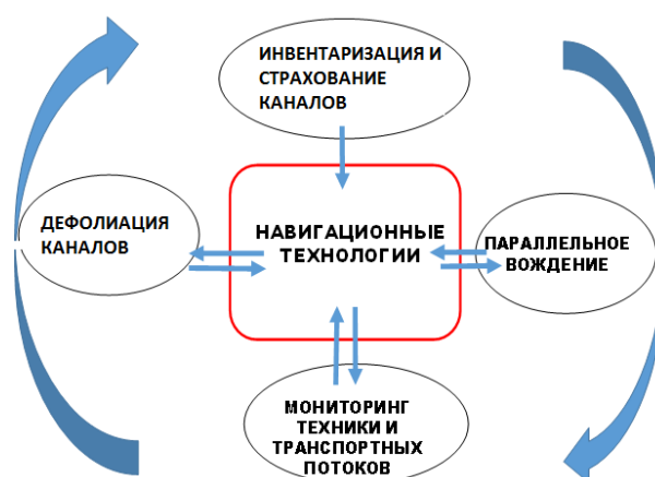
Рисунок 5.3 – Применение навигационных технологий при очистке мелиоративных каналов
