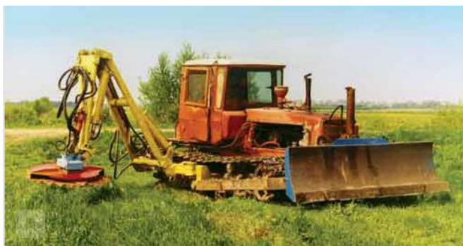
Рисунок 4.10 – Фрезерный рабочий орган для очистки откосов каналов
