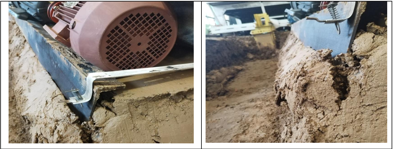
Рисунок 10 – Откос канала (75°) с распределенной нагрузкой по ребру швеллера Результаты расчетов по данному опыту в системе GeoStab 8.1 представлены на рисунке 11. На рисунке 12 представлен анализ призмы сдвига при расчете откоса методом Филлениуса.
