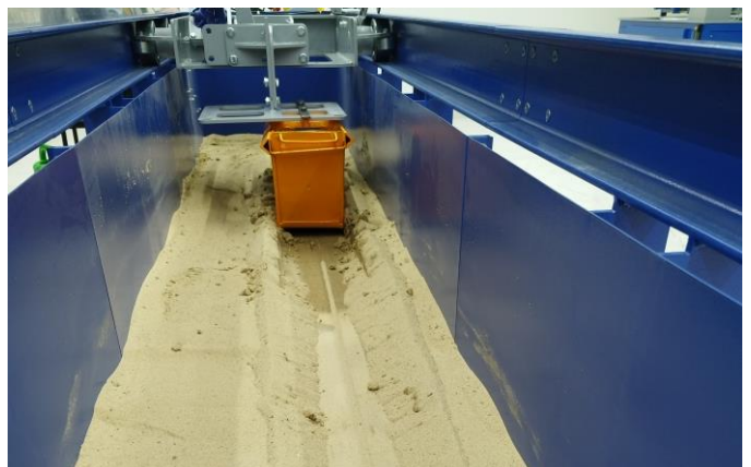
Рисунок 4.32 – Проектирование, изготовление и испытание модели рабочего органа каналоочистителя прямоугольного профиля
