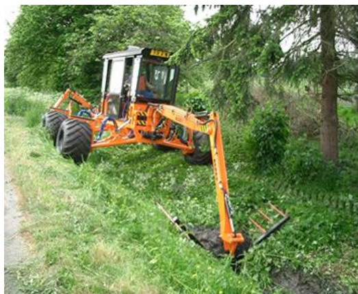
Рисунок 4.14 - Внутриканальный каналоочиститель «Berkenheger» с оборудованием экскаваторного типа
